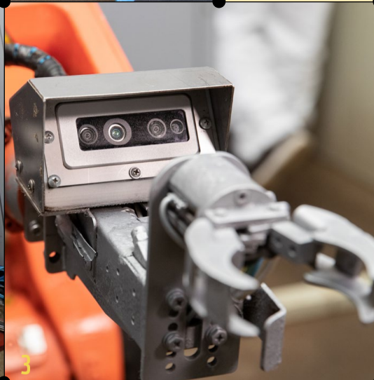
1. 로봇착유기 | 2. 매니플레이터 | 3. 유두인식장치(3D) | 4. 일체형착유컵
